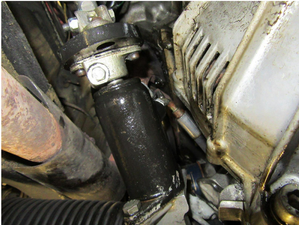
Bild 31 : Leitung Servolenkung undicht.
