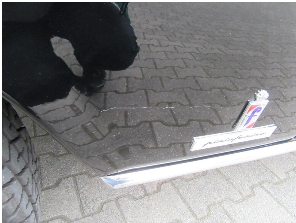
Bild 7 : Kotflügel v l verkratzt.
