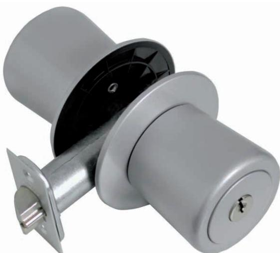
Fácil instalação: apenas 3 peças a montar: puxadores interior e exterior com respectivos mecanismos e um trinco. As fechaduras com chave são equipadas com trinco de segurança. Testa à broca - 63mm (standard), disponível com 80mm. Cilindro de 5 pistões, 2 chaves em latão niqueladas, podendo ser amestradas.
