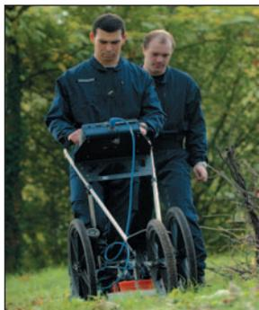
*Sondage de sol par analyse radar.*
