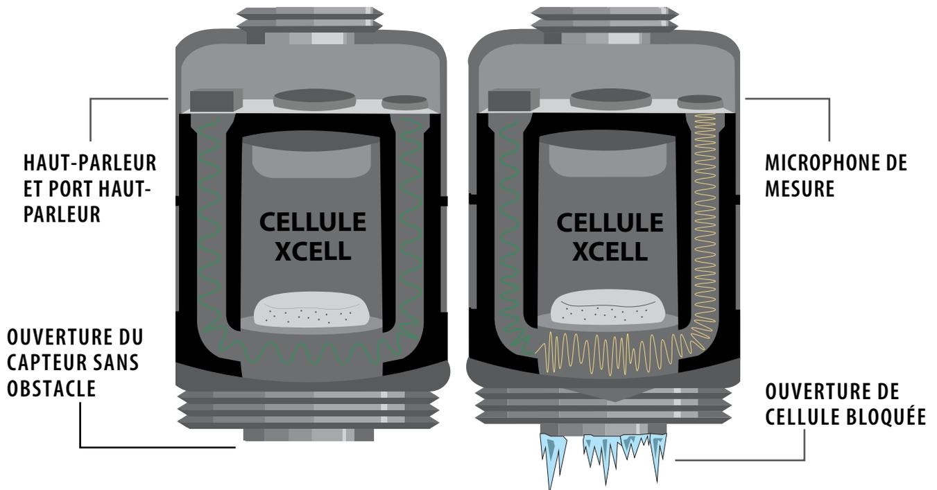
La surveillance de la diffusion vous avertit lorsque le couvercle d'une cellule est bloqué et la rend incapable de détecter les gaz. Elle utilise un concept mécanique acoustique propre et des algorithmes pour mesurer le son à l'entrée de la cellule. Si l'entrée est obstruée par de la glace par exemple, la différence de son est détectée et l'unité se met en défaut. Une fois l'obstruction éliminée, la surveillance de diffusion le détecte et revient à un fonctionnement normal.
