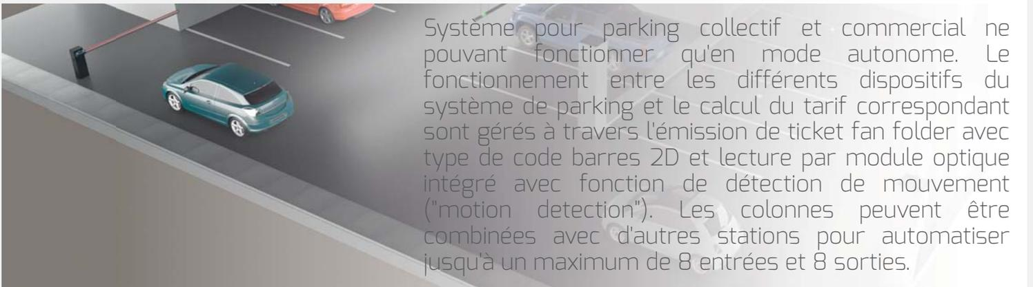
Système pour parking collectif et commercial ne pouvant fonctionner qu'en mode autonome. Le fonctionnement entre les différents dispositifs du système de parking et le calcul du tarif correspondant sont gérés à travers l'émission de ticket fan folder avec type de code barres 2D et lecture par module optique intégré avec fonction de détection de mouvement ("motion detection"). Les colonnes peuvent être combinées avec d'autres stations pour automatiser jusqu'à un maximum de 8 entrées et 8 sorties.
