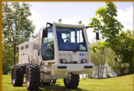
Camion vibreur qui génère des ondes dans le sous-sol
